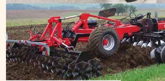
Hátul elhelyezett futómű, Ø 500 mm-es, kétsoros hullámos tárcsasorral
