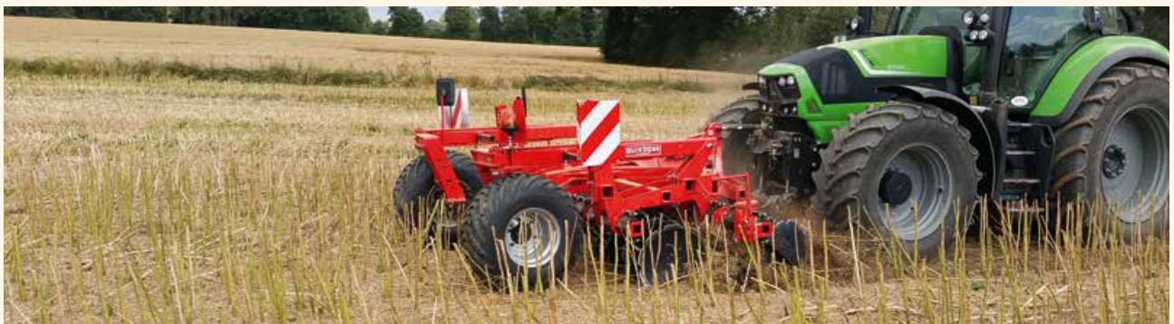
A Stub-Front rövidtárcsa 720 mm-es tárcsasor távolsággal rendelkezik, így kitűnően alkalmazható mind a szármagmaradványokkal borított, mind a szántott talajokon.
